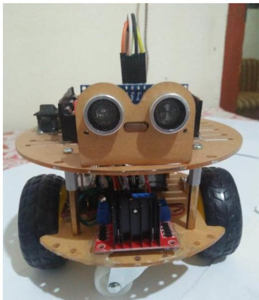
Gambar 7. Chasis Mobile Robot Beserta Komponen Elektronik
