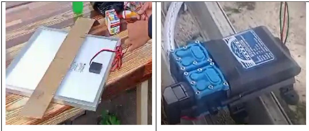
Gambar 3. Pemasangan Instalasi Pompa Dengan Sel Surya 20Watt
