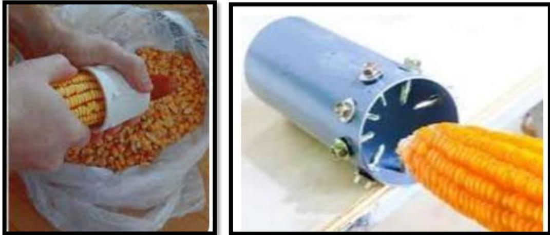
Gambar 1. Proses pemipilan menggunakan pipa PVC diberi paku
