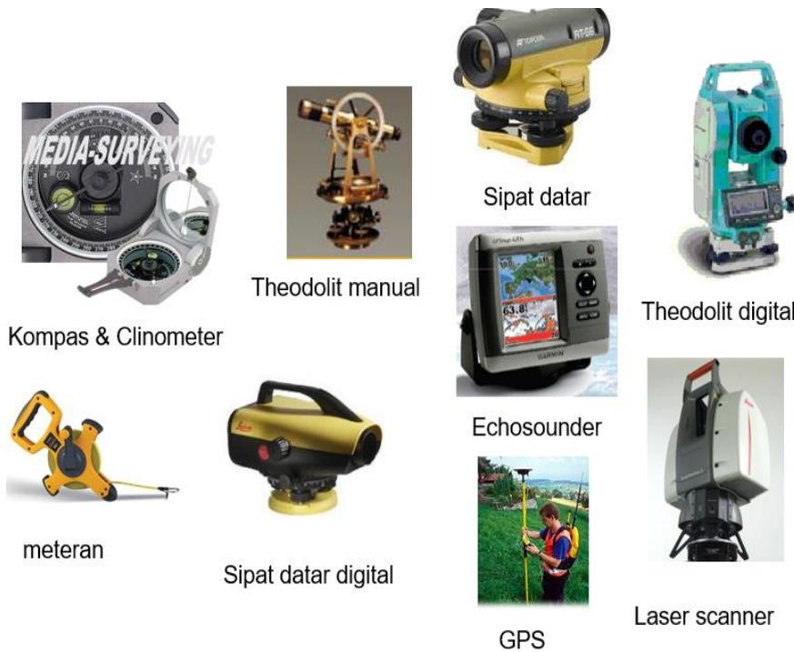
Gambar 2. Alat -Alat Survey dan Pemetaan
